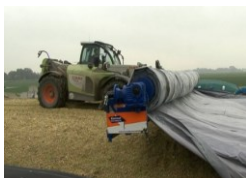
Presenningen rulles ud ved at trække den efter en læssemaskine. Afdækning foregår ved at maskinen med hydraulik ruller den sammen, mens læssemaskinen flytter holderen.
