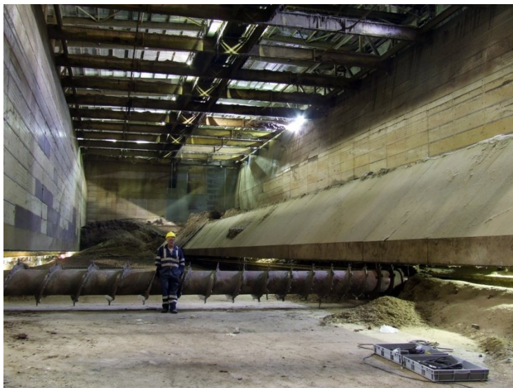
Hollandsk anlæg til opbevaring og indfødning af kyllingemøg
