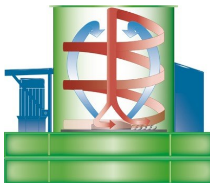
Princippet i en kædeknuser
