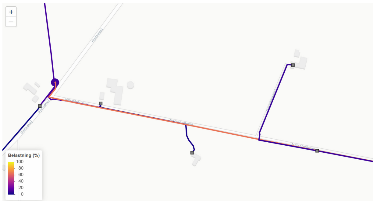
Figur 39 - Belastningsprofil på 10kV strækningen med solcellemarkanlæg tilknyttet.
