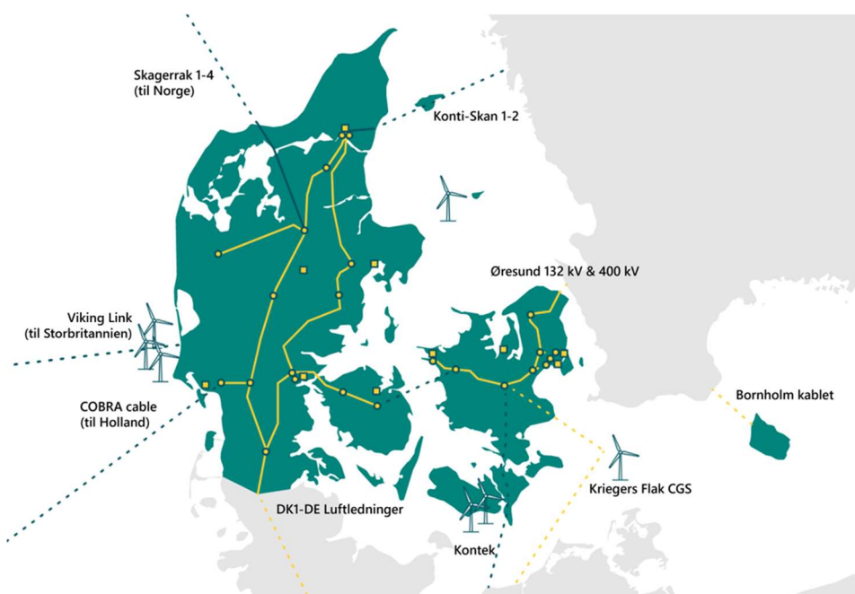
Figur 2: Danske udlandsforbindelser. Blå forbindelser: HVDC; gule forbindelser: AC-forbindelser. Bornholmsforbindelsen inkluderes normalt ikke i Energinets modelberegninger af Østdanmarks elsystem, og er derfor ikke en del af analyseforudsætningerne. Viking Link til Storbritannien er under opførelse og forventes idriftsat ultimo 2023. Kilde: Energinet.
