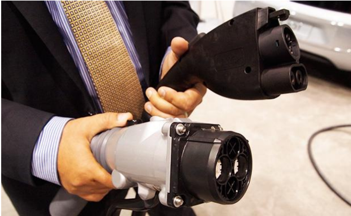
Figur 9 SAE 1772 Combostik (øverst) og Yazaki stikket.
