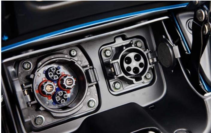
Figur 7 DC (til venstre) og AC opladning af en Nissan Leaf. Billedet er fra www.nissan.com .
