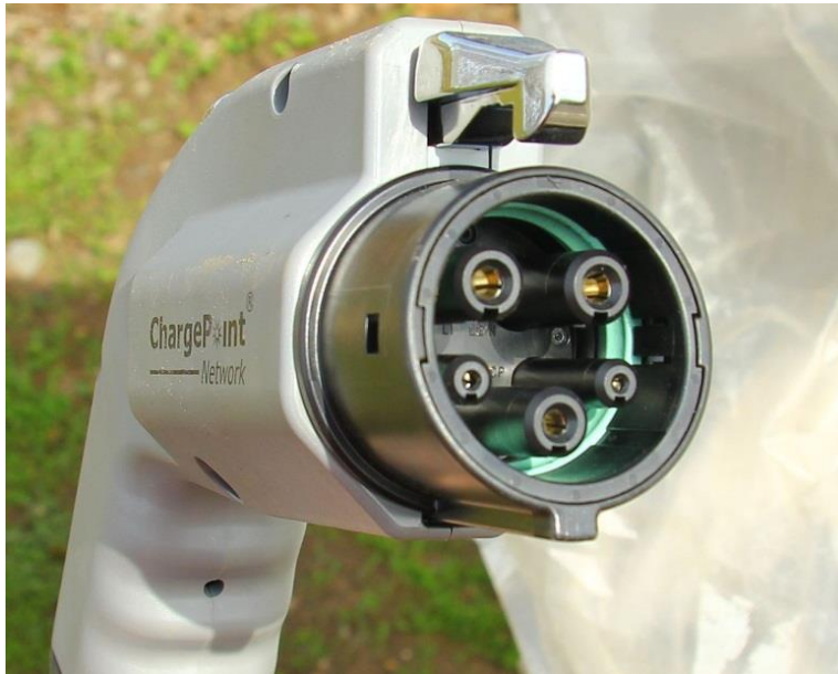
Figur 1 Stik type 1, SAE 1772. Billedet er fra www.chargepoint.com .
