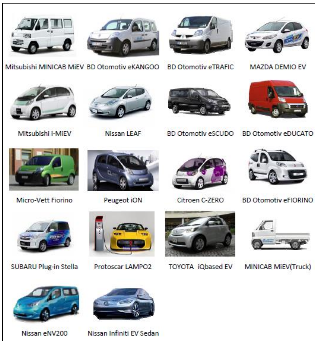
Figur 6 Elbiler der benytter CHAdeMO standarden for DC opladning. Figuren er fra www.chademo.com .
