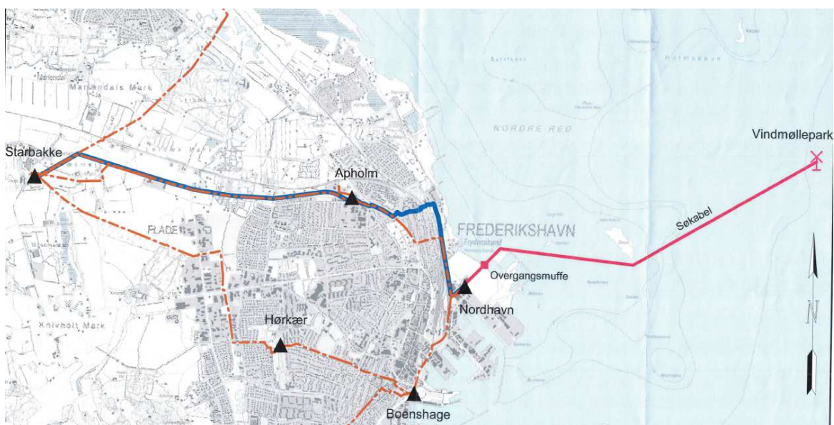
Figur 2 Generisk oversigt over kabelstrækningen for søkablet og kabel på land.
