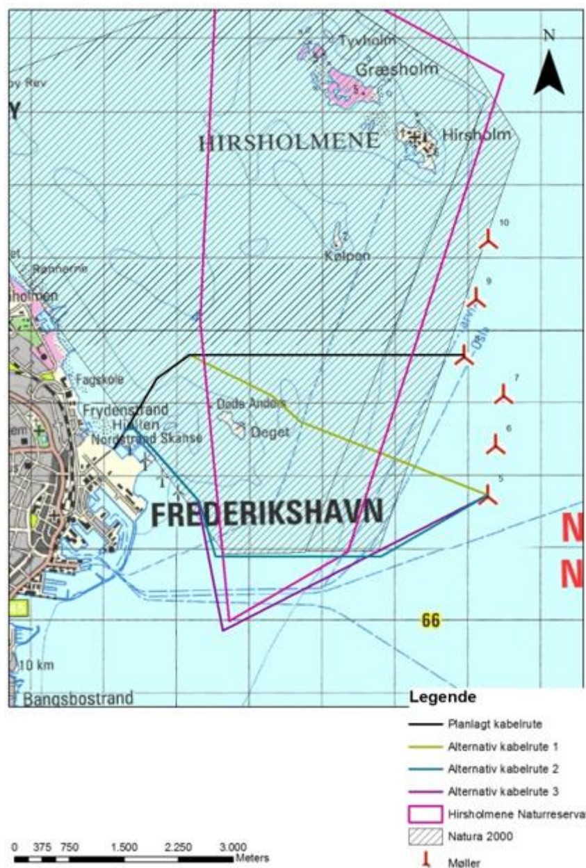
Figur 5.5: Mulige kabelkorridorer fra mølleparken til land.
