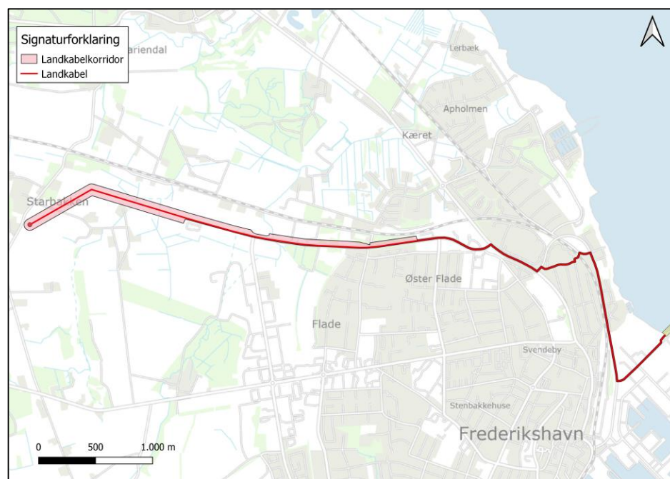
Figur 1.5: Oversigt over land-kabel og kabeltracé.
