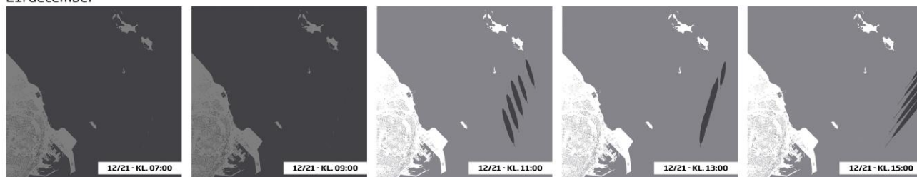
Figur 6.13 Skyggediagrammer, der illustrerer møllernes skyggekast fordelt over fire døgn på fire forskellige årstider. Bemærk, at skyggediagrammet alene viser skygger fra møllerne, men at der under eksisterende forhold også er skygger fra mange forskellige elementer, eksempelvis på havnen.
