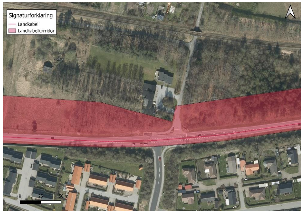
Figur 4.15: Vestlige del af kabelkorridor indsnævret ved bygge.
