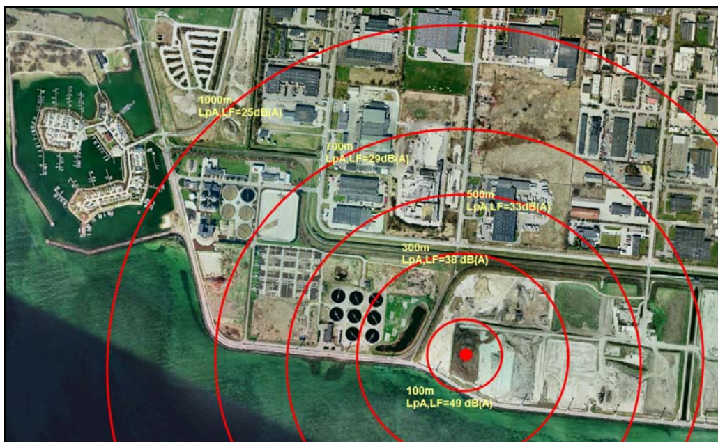
Figur 7.26 Resultater af beregninger af den lavfrekvente udendørs støj fra én kompaktor og to gravemaskiner, der arbejder samtidigt på AV Miljø's areal ved den røde prik.
