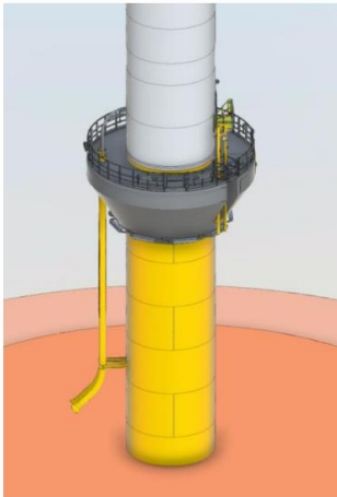
Figur 4-5. Monopæl fundament med iskonus i beton, hvorpå platform, landgang mm. er monteret.
