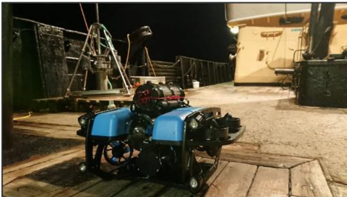
Figur 8-16 Foto af WSPs ROV – BlueROV2 fra Bluerobotics, her anvendt i forbindelse med en anden marin kortlægningsopgave.
