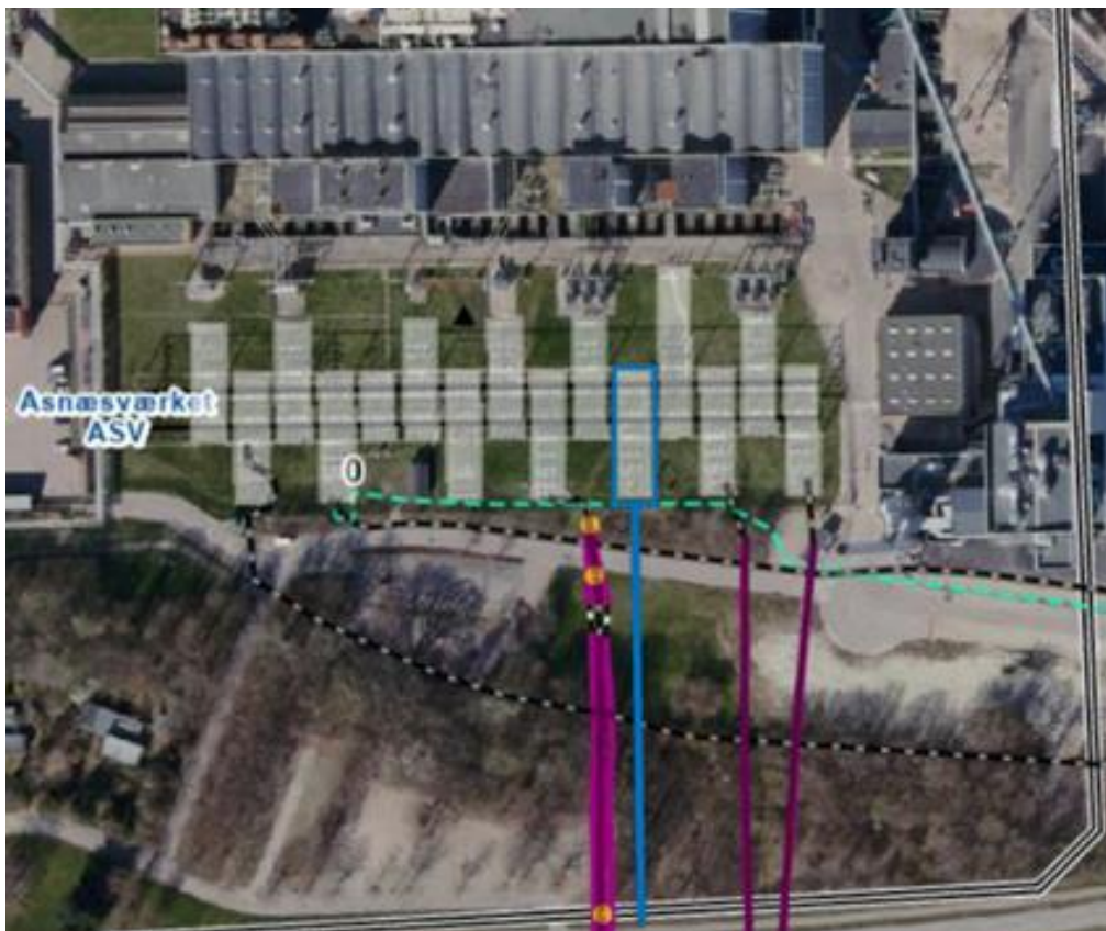
Figur 4-13 132 kV tilslutningsfelt ved Asnæsværket, angivet med blå markering. Lilla markering viser eksisterende ledninger i området.
